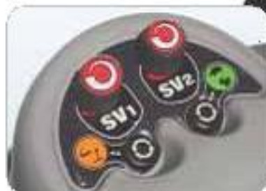
Las memorias de las velocidades SV1/SV2, los modos de funcionamiento de la transmisión Dyna-VT y la selección de gamas agrupadas en un cómodo 'paquete'
